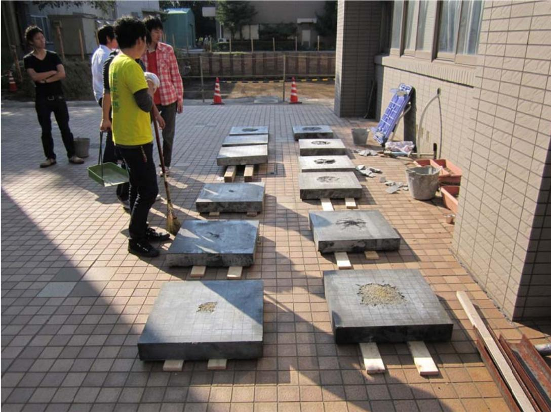
爆発実験後の試験体
