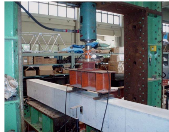
RC梁のプレート曲げ補強
