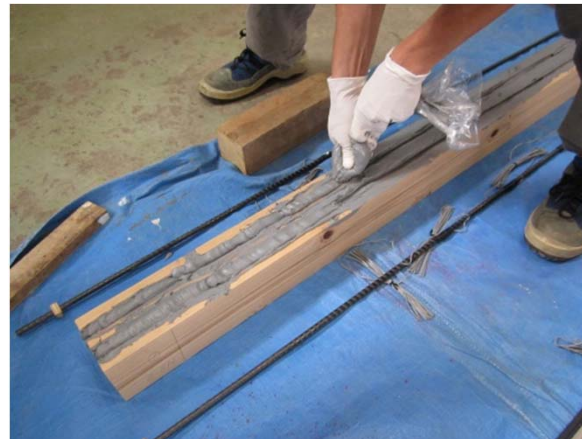
CFRPロッド埋設補強木造梁の曲げ載荷試験
