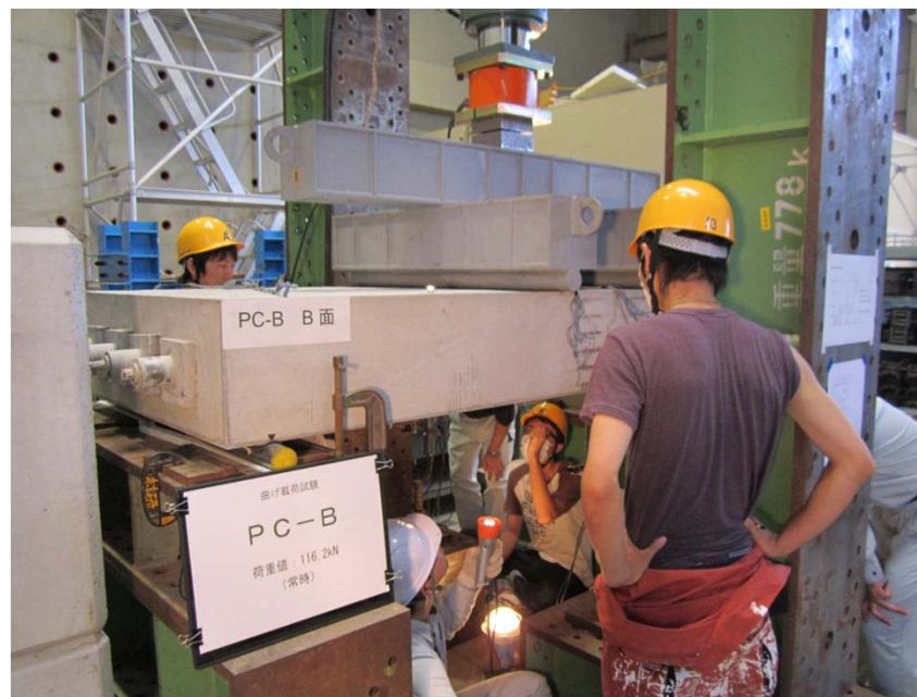
RCスラブ試験体の曲げ載荷 プレキャストRCスラブのPC圧着
