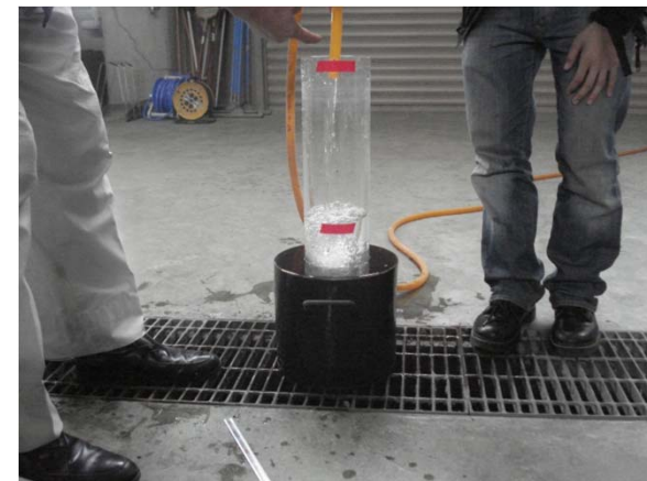
簡易透水舗装への利用 (変水位透水試験)
