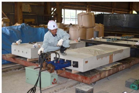
RCスラブ試験体の曲げ載荷 プレキャストRCスラブのPC圧着
