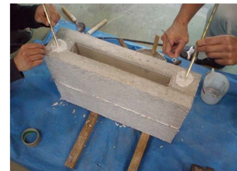
中空PCaブロック版 (50mm × 2) + 中空層(50mm)
