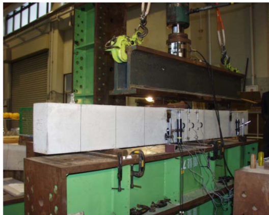
RC梁のシートせん断補強
