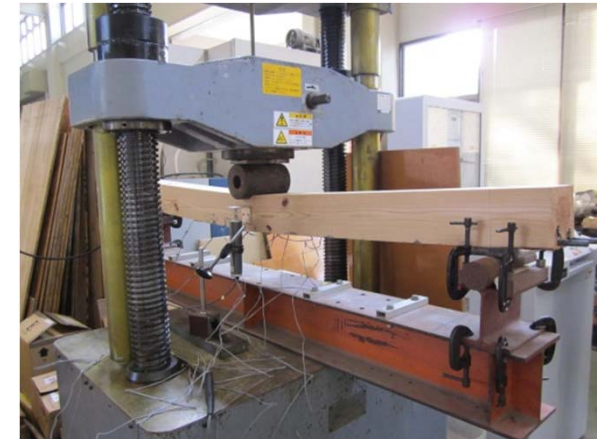
CFRPロッド埋設補強木造梁の曲げ載荷試験
