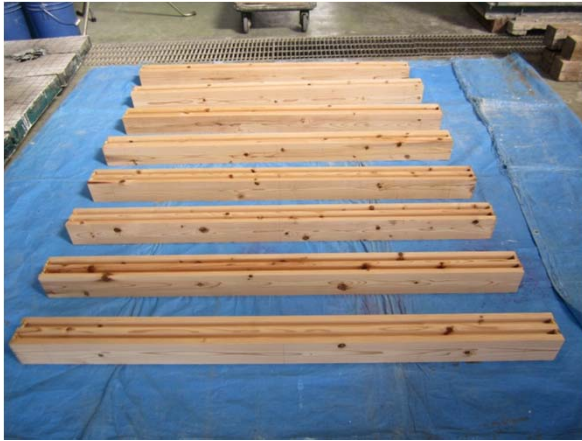
すぎ角材の溝加工と埋設CFRPロッド
