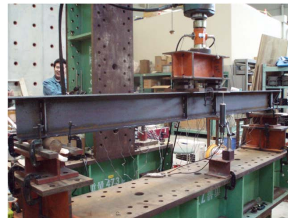
S梁のプレート曲げ補強
