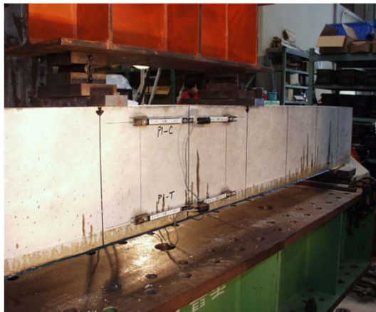
RC梁のシート曲げ補強
